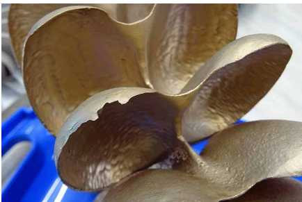
Am alten Peltonrad sind die Erosionsschäden deutlich zu sehen.
